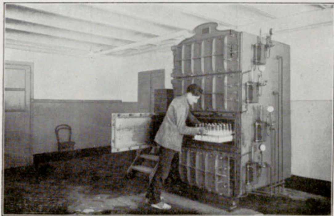
Autoclave para la pasteurización de biberones
